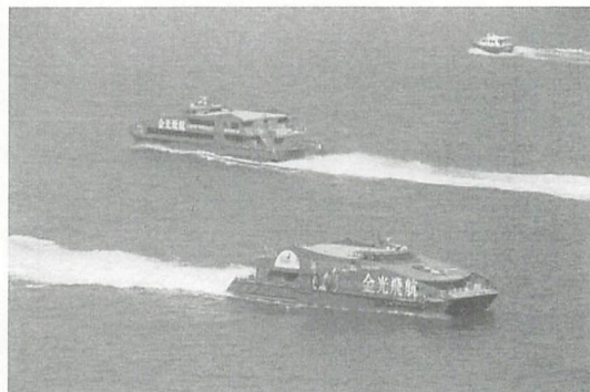
コタイジェット社が運航する2隻の双胴高速旅客船が港内で行きかう。オーストラリアのオースタル・シップ建造の700総トン、乗客411名、40ノットの超高速船で、香港～マカオ航路に8隻が投入されている。
