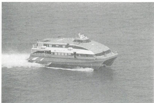
双胴の全没翼型水中翼船「ペンハ」。香港～マカオ間を45分で結ぶ。561総トン、407名定員、最大45ノット。姉妹船1隻も同航路に就航している。
