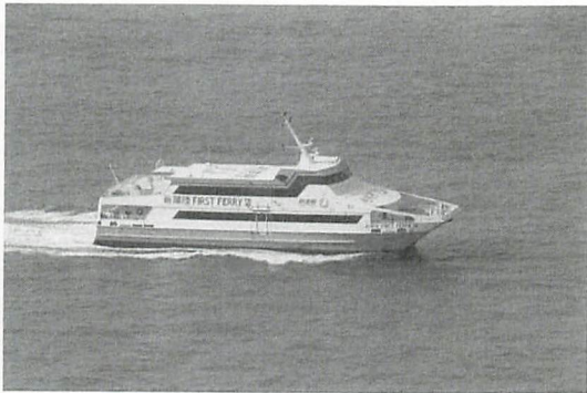
ファーストフェリーの高速旅客船「ファーストフェリーⅥ」。シンガポールで建造された高速船で、422総トン、397名定員、25.5ノット。
